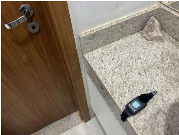
Início das aferições de ruído na sala receptora
